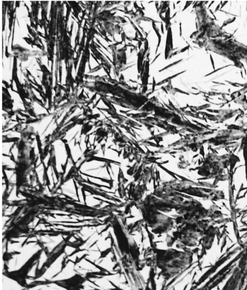
Photomicrograph แสดงโครงสร้างของ Martensite (1220x)
