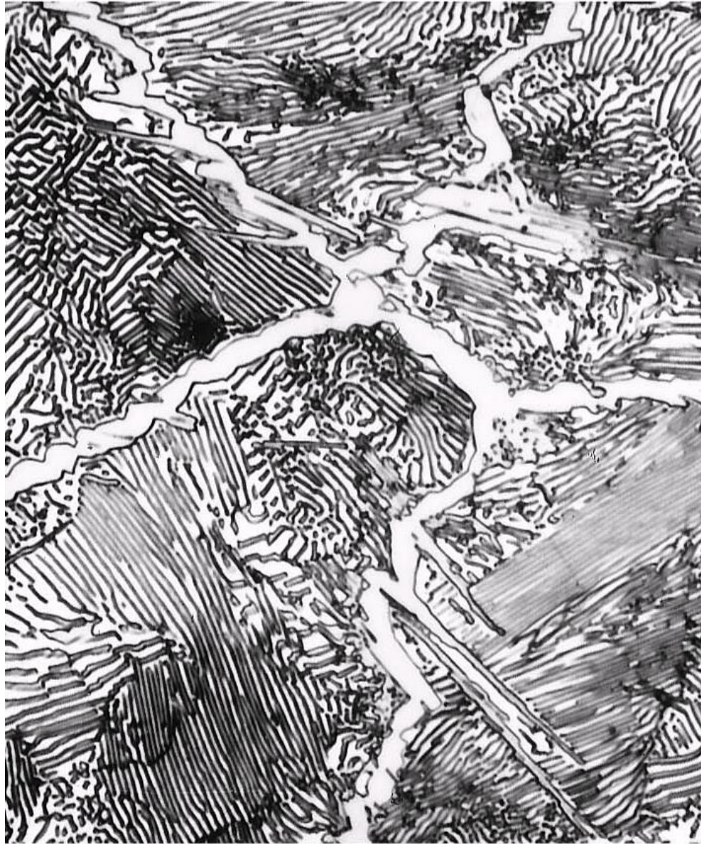
ภาพถ่ายของโครงสร้าง Hypereutectoid steel 1.4 wt%C (1000x)
